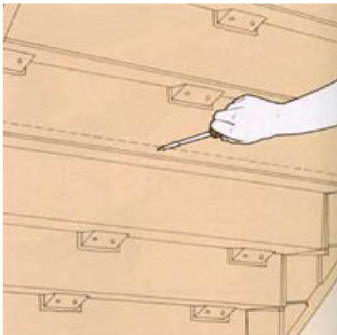
Чтобы определить размер проступи, необходимо обратиться к стандартам DIN 1052 и DIN 1055, где и описаны методы подсчета толщины проступи. При использовании балки на двух опорах ее минимальное значение должно равняться 50мм.
